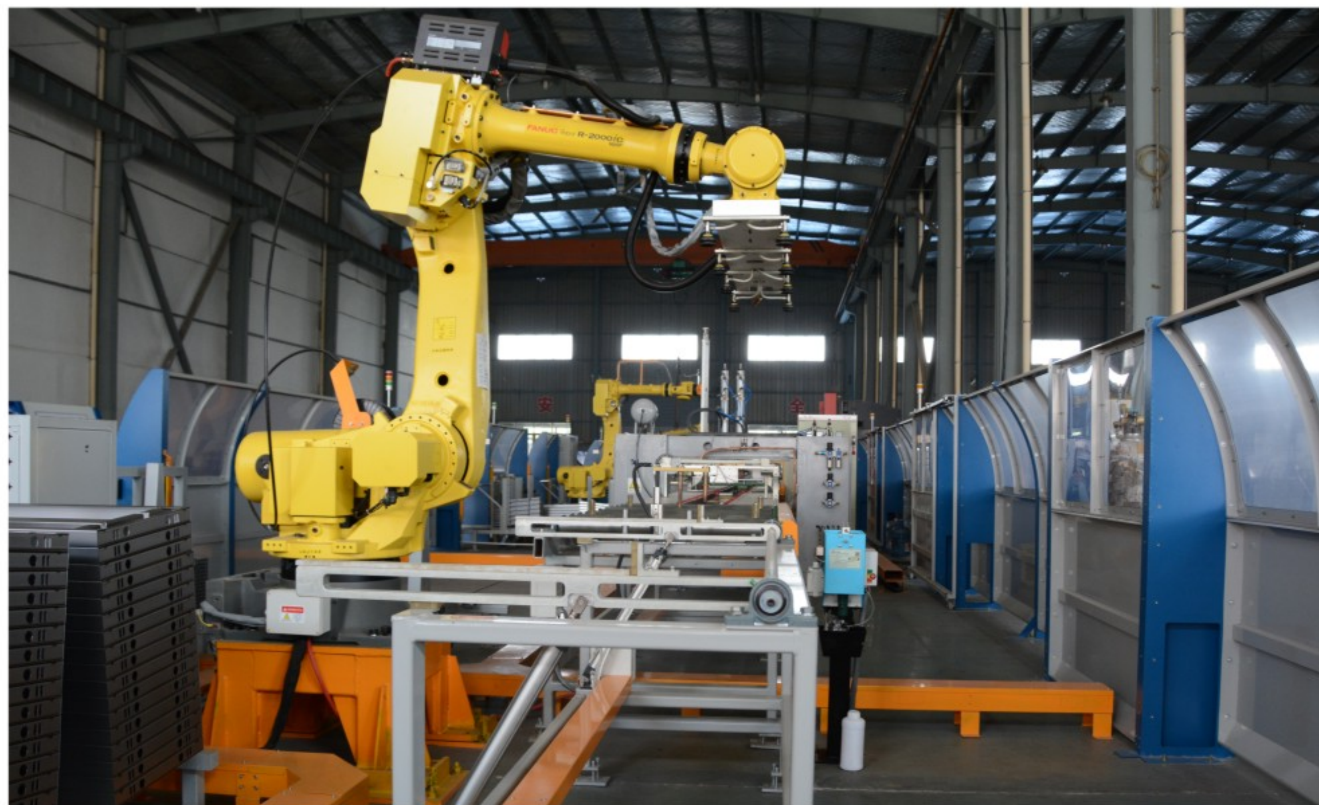
标准电梯门板机器人生产线
